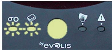
Anzeige am Bedienfeld: MECHANISCHE STÖRUNG. Der Druckvorgang wird unterbrochen.
