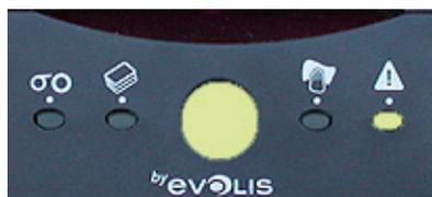
Wird der Drucker nach 400 gedruckten Karten nicht gereinigt, leuchtet das Reinigungsleuchtchen dauerhaft und beginnt nach dem Druck weiterer 100 Karten zu blinken. Stoppen Sie in diesem Fall sofort den laufenden Druckauftrag und reinigen Sie den Drucker.
