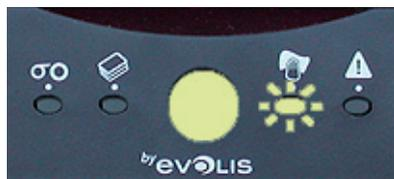
Wir empfehlen generell, den Drucker bei jedem Bandwechsel zu reinigen. Zusätzlich wird am Badgy aber auch angezeigt, wenn eine Reinigung erforderlich ist: Nach jeweils 400 bedruckten Karten beginnt das Reinigungsleuchtchen am Bedienfeld des Druckers zu leuchten.
