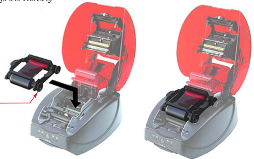
Das Druckband wird bei Start des nächsten Druckvorgangs automatisch ausgerichtet.
